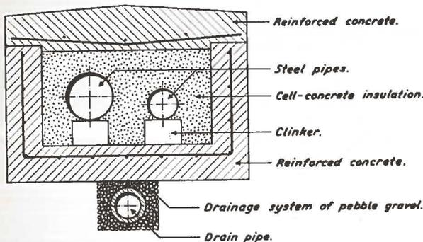
FIG. 7—Conduit Cross Section.
